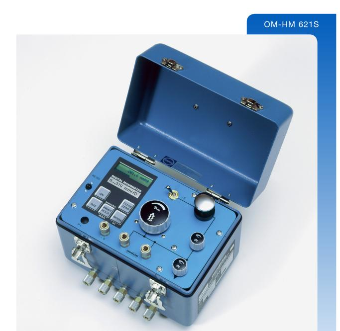
Der OM-HM 621 S ist ein Druckmesskoffer zur Kalibrierung von nichtinvasiven Blutdruckmessgeräten. Eingebaut ist ein Digitalmanometer des schweizerischen Herstellers HUBER AG, das sich durch hohe Genauigkeit, Temperaturkompensation und Langzeitstabilität auszeichnet. Die Druckerzeugung erfolgt mit der eingebauten Handpumpe. Das Variovolumen
